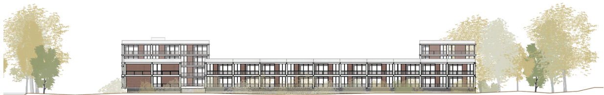
Abbildung 36: Südostfassade mit sichtbarer Sockelbildung von 1.0 – 1.20 m
